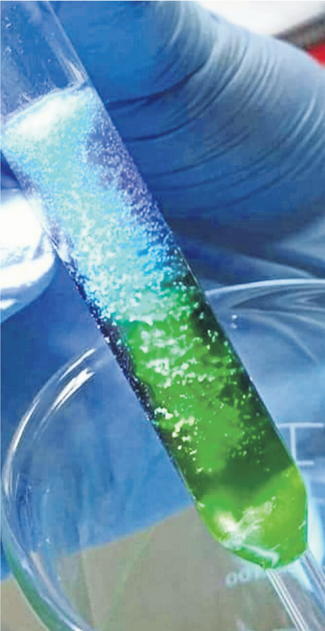
Quimiosensor molecular sintetizado en el laboratorio para la detección de nucleótidos.
