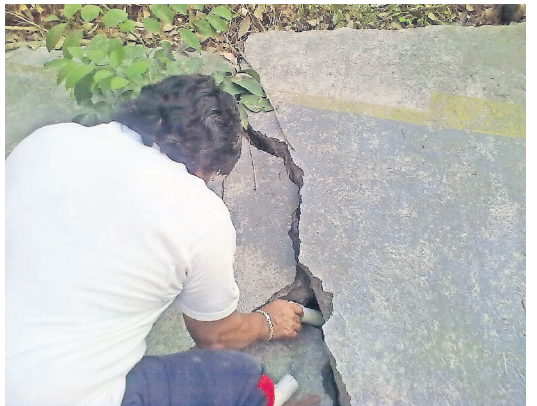
El investigador coloca un detector pasivo CR-39 en una grieta de la falla.
