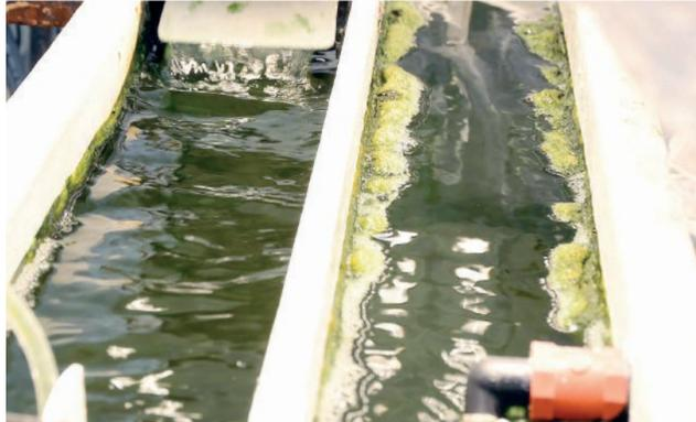
Fotobiorreactor para intensificar el crecimiento de microalgas.
