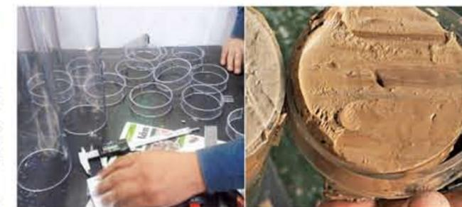
**LODO MARINO.** Fabricación de los tubos de policarbonato y muestra extraída
