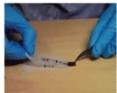
CAPAS. Se obtuvieron capas de grafeno a partir de hojuelas de grafito
