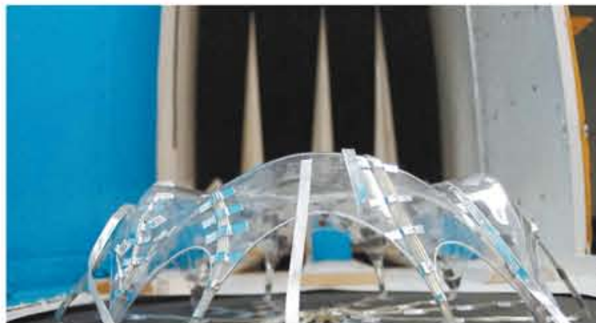
TÚNEL DEL VIENTO. Puede reproducir vientos hasta de 244 kilómetros por hora
