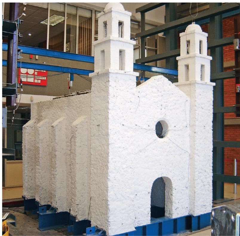
Templo a escala sometido a la acción de diferentes sismos en una mesa vibradora.
